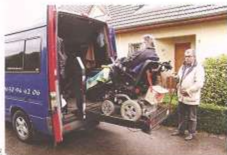
La rampe hydraulique, dans laquelle Gérard Ketterlin a investi, permet l'accès à des fauteuils roulants et électriques pouvant atteindre 200 kg.
